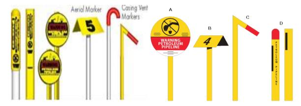
Marcador de tubería- Este marcador es el más común. Contiene información del operador, tipo de producto y un número de contacto de emergencia. El tamaño, la forma y el color pueden variar Marcador aéreo - Estos marcadores orientados hacia el cielo son utilizados por los aviones de patrulla que monitorean las rutas de la tubería.
